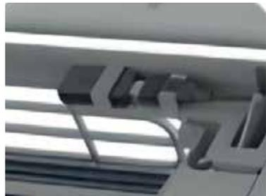
4. Подсоедините Wi-Fi модуль к разъему. Закройте панель кондиционера.
