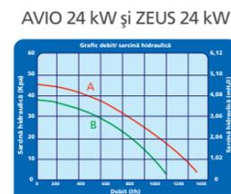
**Legendă** Sarcină hidraulică disponibilă pentru instalație cu by-pass-ul parțial deschis (reglaj de serie):
